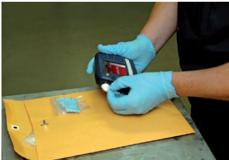
La spectroscopie Raman peut-être appliquée à l'analyse des stupéfiants, ici avec l'analyseur portable Thermo Scientific™ TruNarc™ Handheld Narcotics Analyzer.
